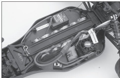
Installazione tipica vettura elettrica
