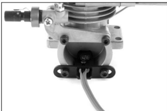
**A noter:** Il se peut, sur certains moteur, qu'il faille éloigner le capteur un peu plus de la plaque arrière. Le capteur ne détecte que la tête de bielle; sur certains moteurs, si l'on rapproche trop le capteur il ne fera pas la différence entre la tête de bielle et le vilebrequin.
